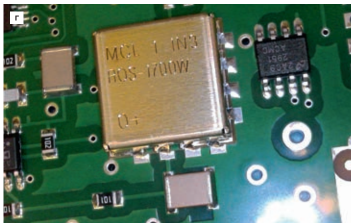
Компоненты после отмывки щелочной жидкостью (а, б) и pH-нейтральной жидкостью Гидронол® Н18 (в, г)
