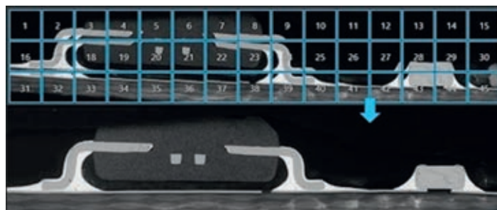
Получение и сшивание последовательности из 45 изображений BSE высокого разрешения с использованием режима панорамы Сохет. Изображение предоставлено: COXEM Co. Ltd.
