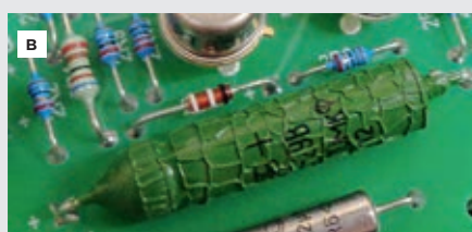
4 Влияние pH-нейтральных отмывочных жидкостей различных отечественных производителей на компоненты: а – Гидронол® Н18 (нет повреждения маркировки, компонентов и герметизации); б – Гидронол® Н18 (нет повреждения компонентов и герметизации); в – другая pH-нейтральная жидкость (повреждение напыления обволакивания компонента); г – другая pH-нейтральная жидкость (повреждение корпуса компонента)
