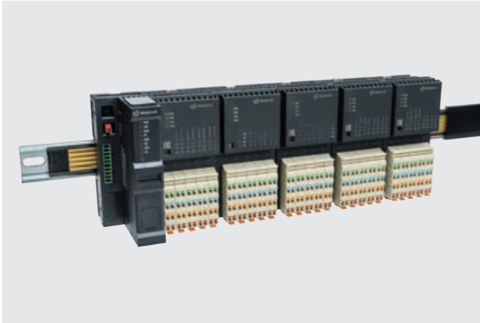
ПЛК с модулями ввода и вывода разработки ООО «Континент ЭТС»
